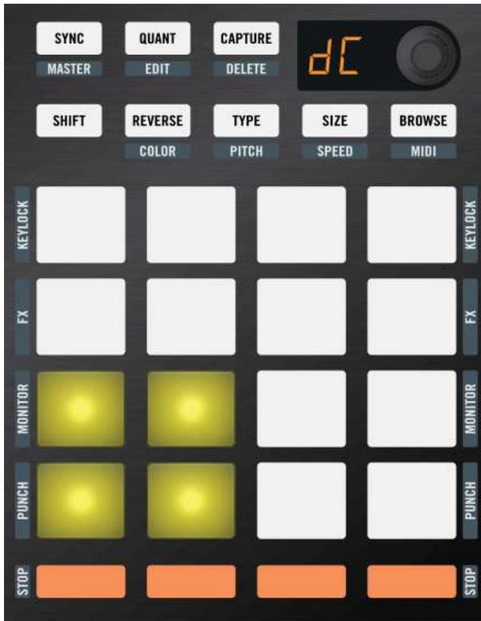
El visualizador y el cuadrante inferior izquierdo del F1 indican que la cubierta controlada es la Cubierta C.
