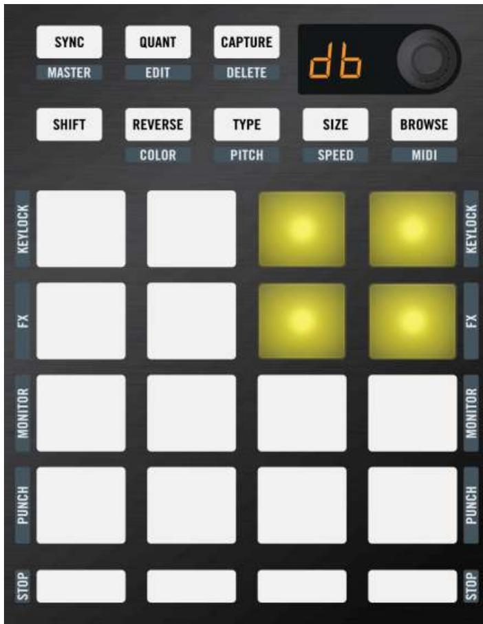
El visualizador mostrando "db" y el cuadrante superior derecho de la matriz de pads se ilumina para indicar que el foco está puesto sobre la Cubierta B de TRAKTOR.
