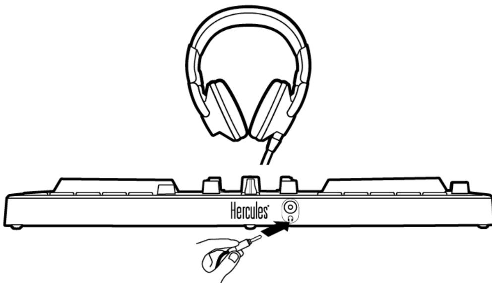
De forma predeterminada, cada vez que se conecta el producto, la salida de auriculares se asigna a la salida 3-4 de modo que pueda funcionar con todo el software de DJing disponible en el mercado, incluyendo *DJUCED*<sup>®</sup>, en particular.
